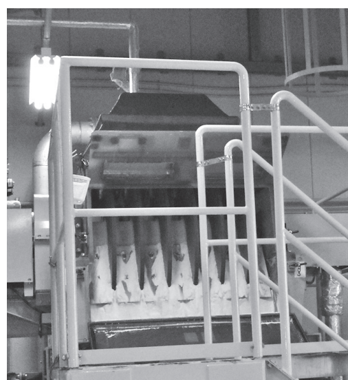
令和4年度1カ月平均約5トンの精製塩が発生 (エコ小野上処分場脱塩処理装置)
